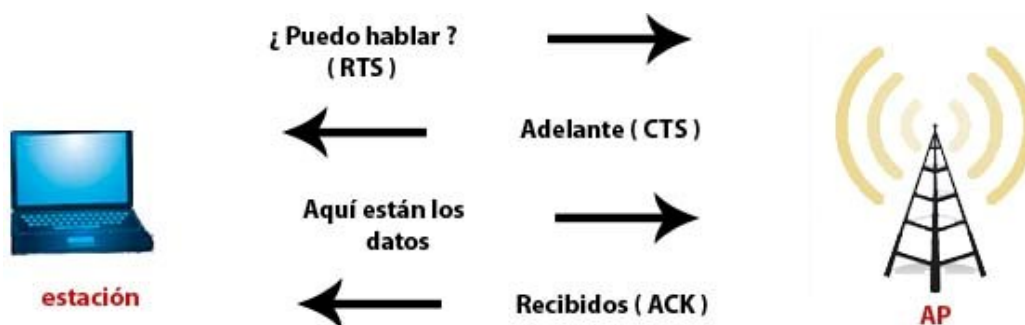
Figura 2.2 Funcionamiento de WiFi
