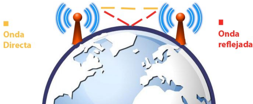
Figura 1.7 Enlace de microondas de línea de vista
