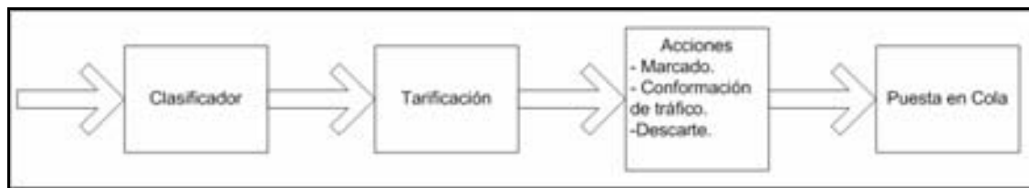
Figura 20: Relación entre las funciones de control DiffServ en el punto de entrada de un dominio.
