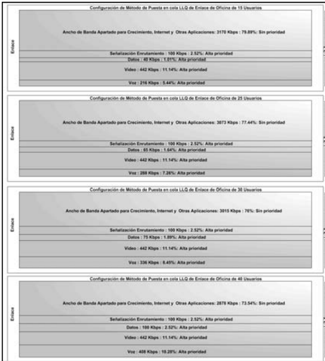
Figura 36: Diagrama de carga de enlace para LLQ de propuesta de red basada en enlaces dedicados.
