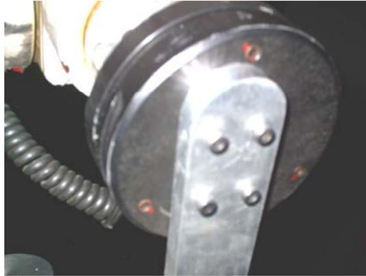
Figura 4.1.1-A. Soporte de la Pistola Rociadora al brazo mecánico
