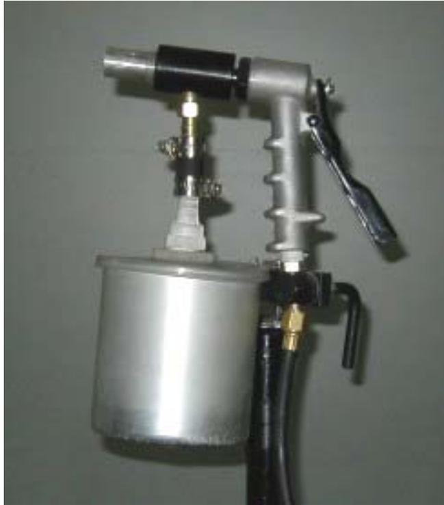
Figura 1.4.7. Granallador con sistema de succión que se utilizará en este trabajo
