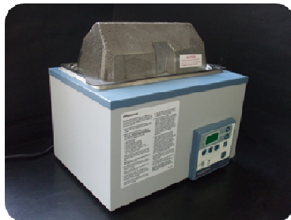
Fig. 44. Cabina a 37 \pm 1^\circ \text{C} y 90% HR.
