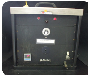
Fig. 32. Colocación del molde dentro de la estufa a 37 \pm 1^\circ \text{C} y 90% HR.
