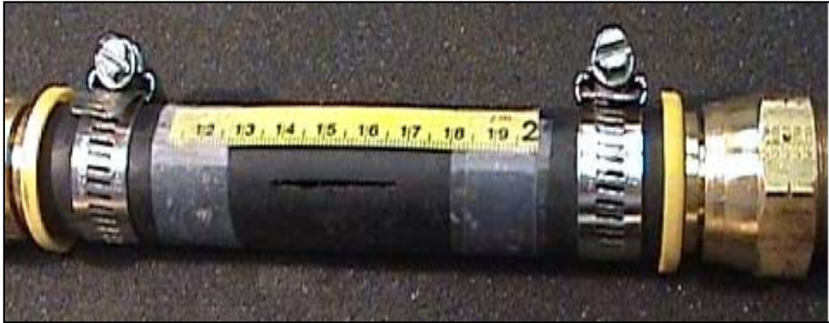
Figura II.12. Espécimen ensayado en la prueba # 4 (ranura)
