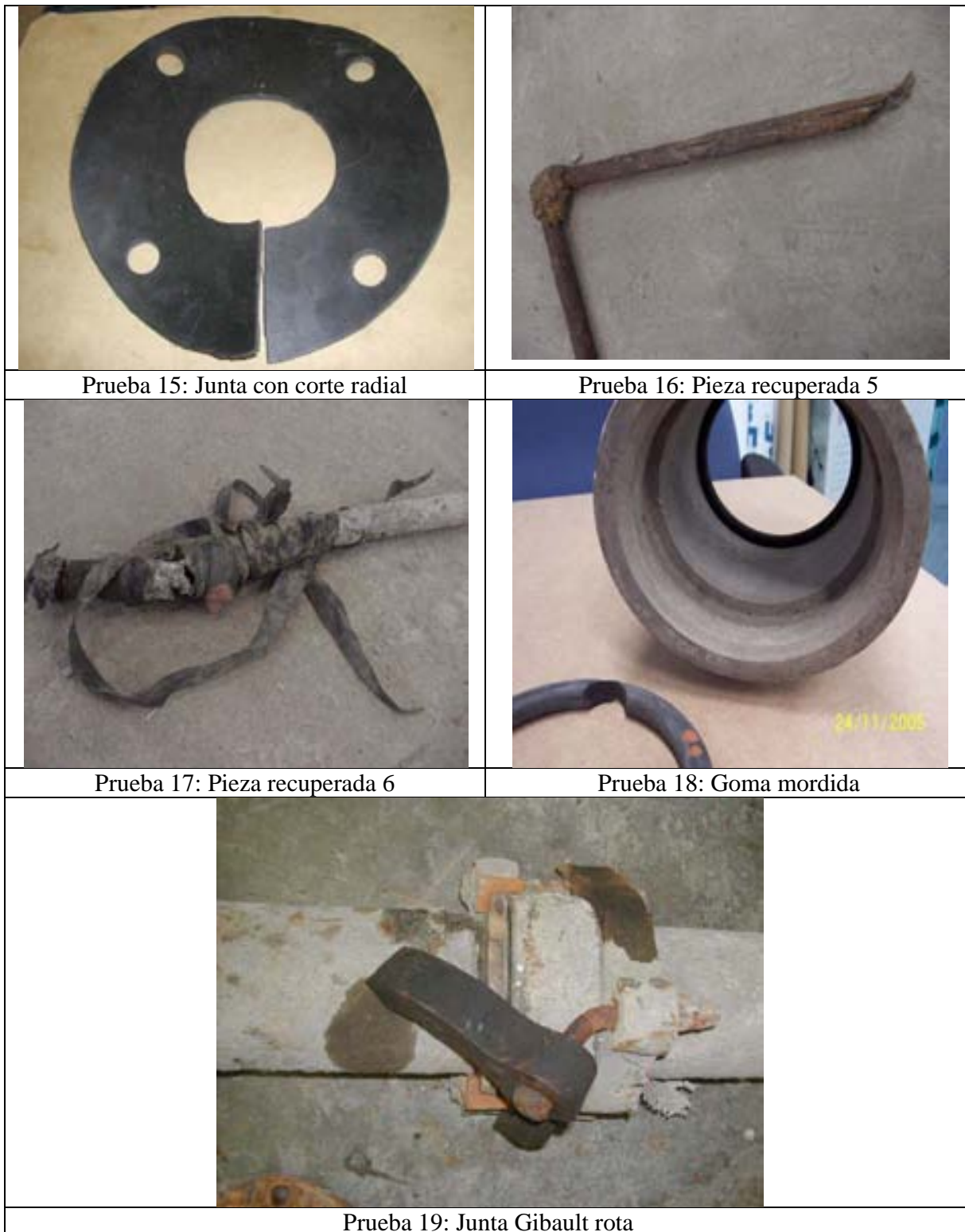
Figura II.19. Piezas recuperadas y piezas especiales
