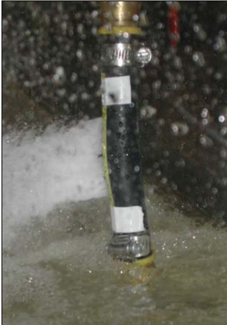
Figura II.10. Espécimen ensayado a una presión de 38 mca
