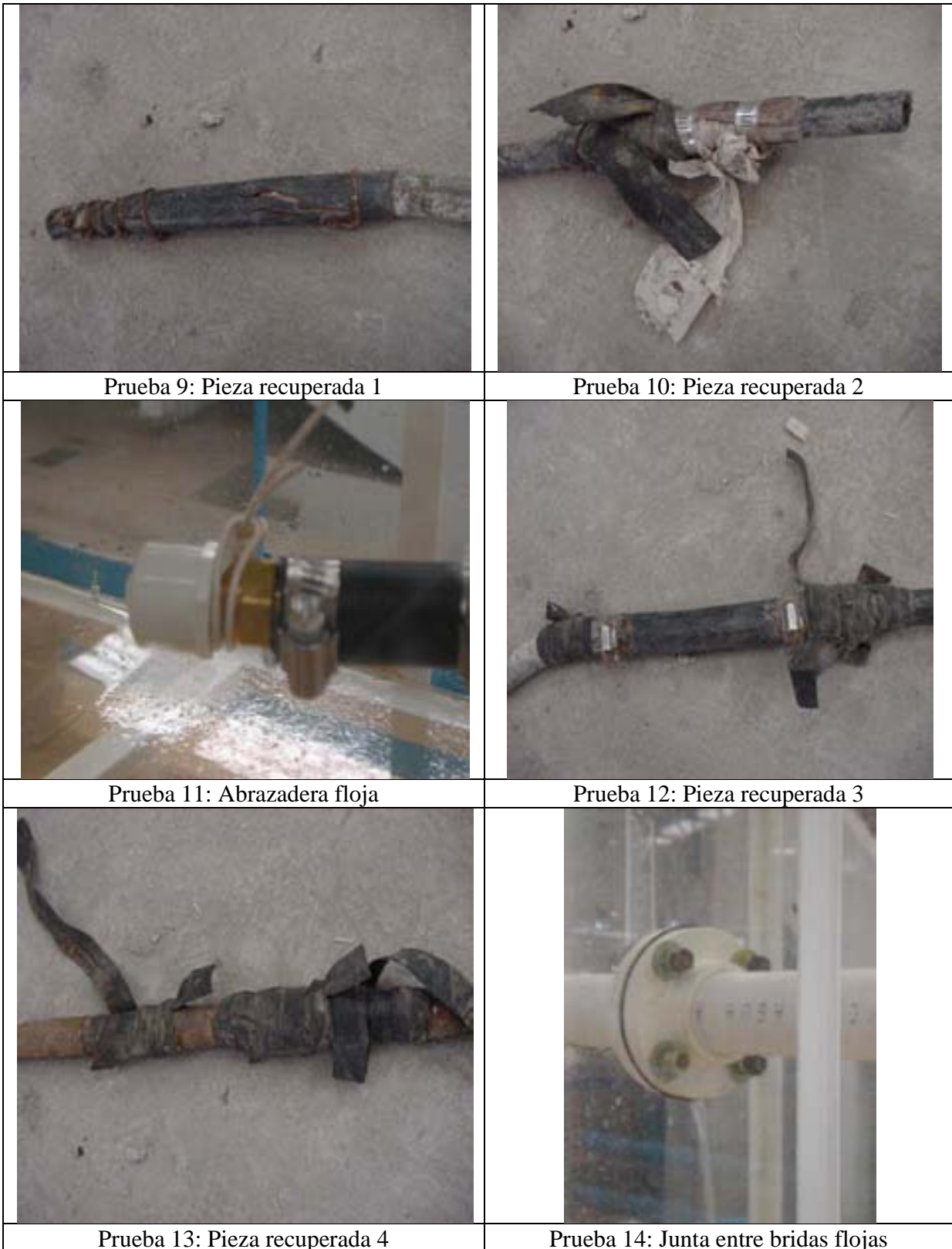
Figura II.18. Piezas recuperadas y piezas especiales
