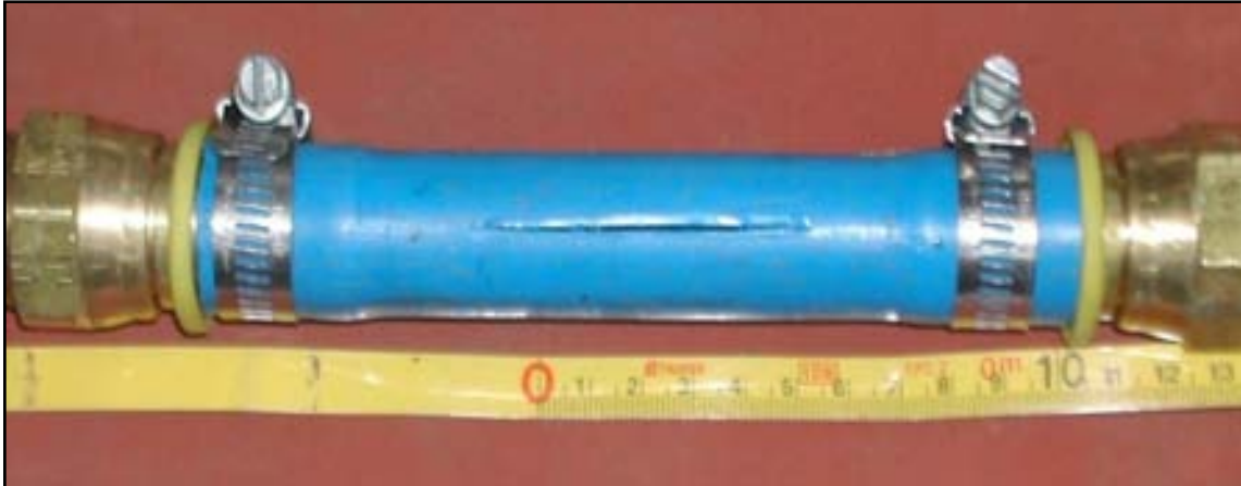
Figura II.14. La fisura en este material muestra una deformación permanentemente después del ensayo
