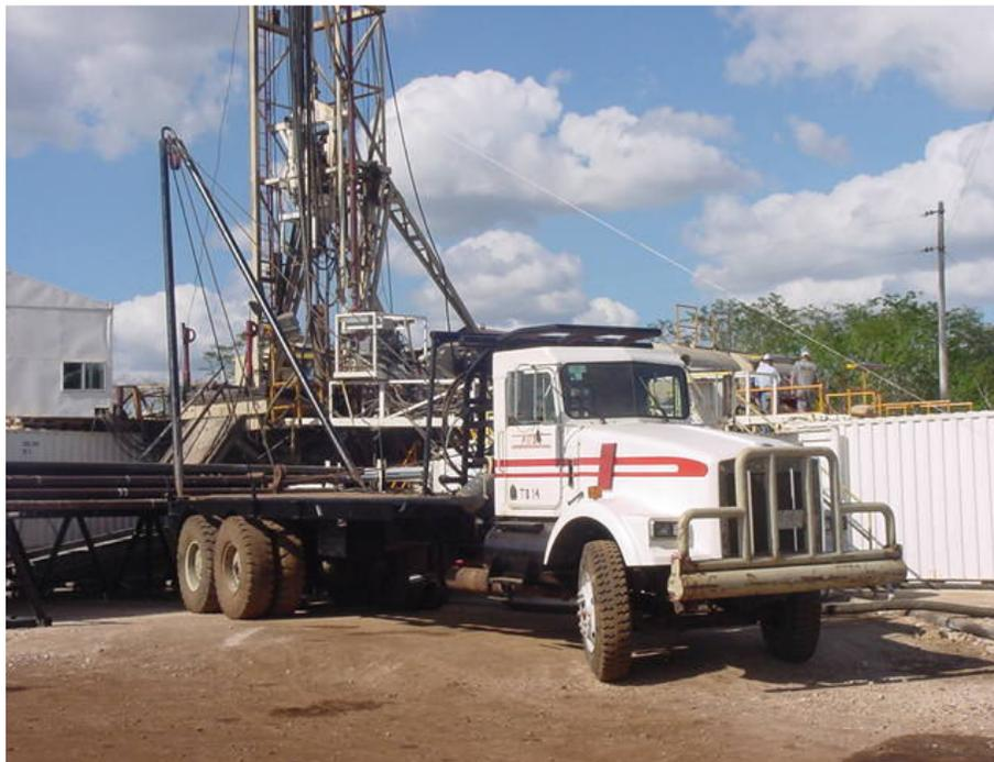
Fig. 3.9 La figura nos muestra el tipo de camiones que se utilizaron para el manejo de la tubería que se introdujo durante todo el proceso
