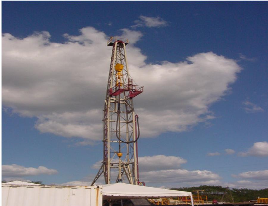
Fig. 3.8 La figura nos muestra a la torre de perforación así como a la polea viajera la changuera y la línea conductora del fluido de perforación utilizados durante la perforación del pozo Yaxcopoil-1
