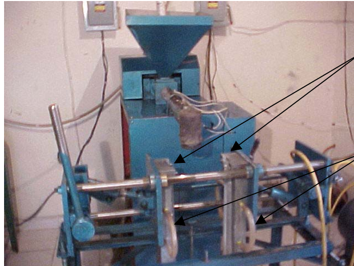
Disposición del molde en la máquina y los ductos de enfriamiento.
