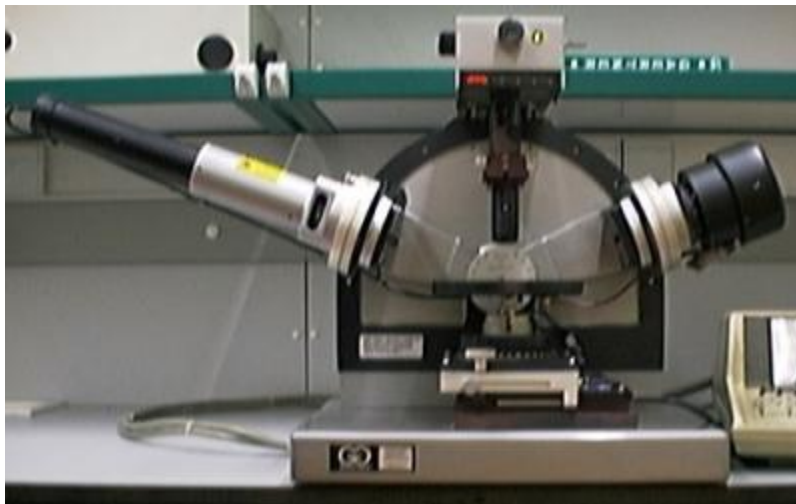
Figura 16. Fotografía de un elipsómetro de nulidad.
