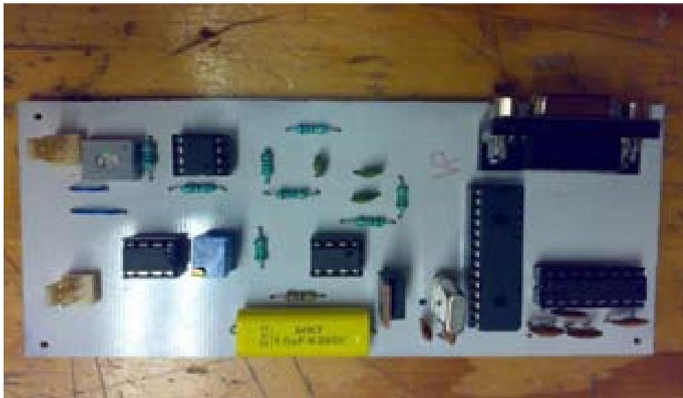
Figura 5.12 Circuito impreso del Electrocardiógrafo con salida gráfica a PC
