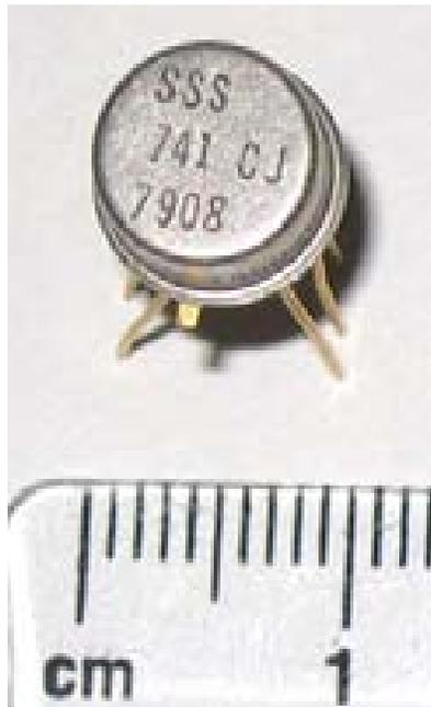
Figura 2.1. Amplificador operacional con encapsulado metálico.
