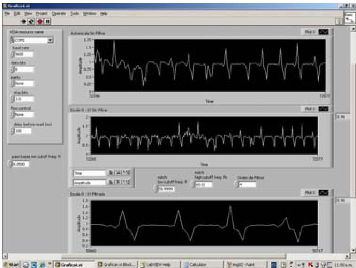
Figura 5.9 Visualización en LabView del electrocardiógrafo.
