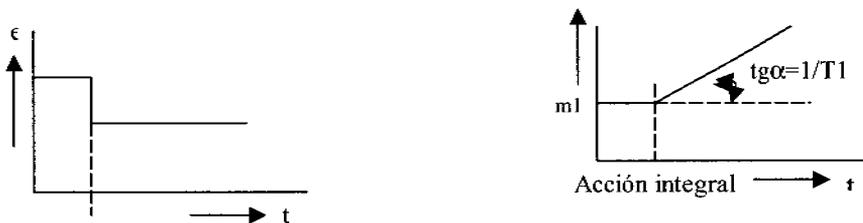
Figura 3.21 señal de control en modo integral.
