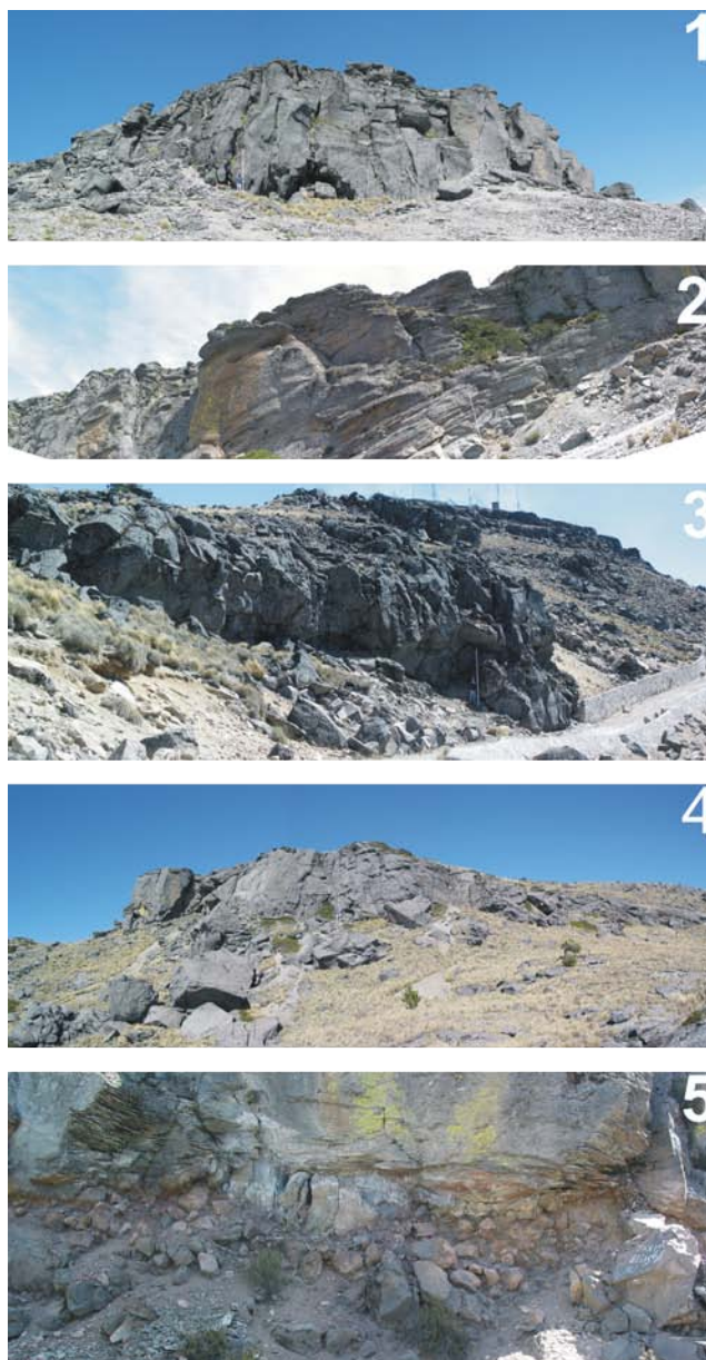
Figura VI.4 Fotografías utilizadas para determinar la calidad de los muros de roca (GSI). Los números corresponden al consecutivo utilizado en la tabla VI.1
