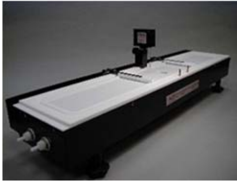
Figura 18. Palangana de Langmuir utilizada en este trabajo, modelo TBK 2410 a , (Nima Techology Ltd; Inglaterra) [24].
