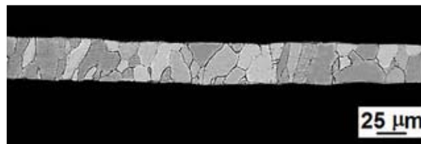
Figura 6.2.7 Micrografías ópticas de las cintas metálicas de composición Fe-40Al-5Cr % at., obtenidas mediante la técnica de melt-spinning, producidas con una velocidad tangencial de rueda de 16 \text{ ms}^{-1} .
