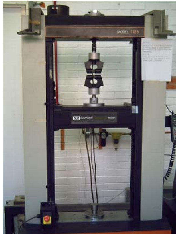
Figura 5.16 Máquina universal para ensayos de tensión, marca Instron modelo 1125.
