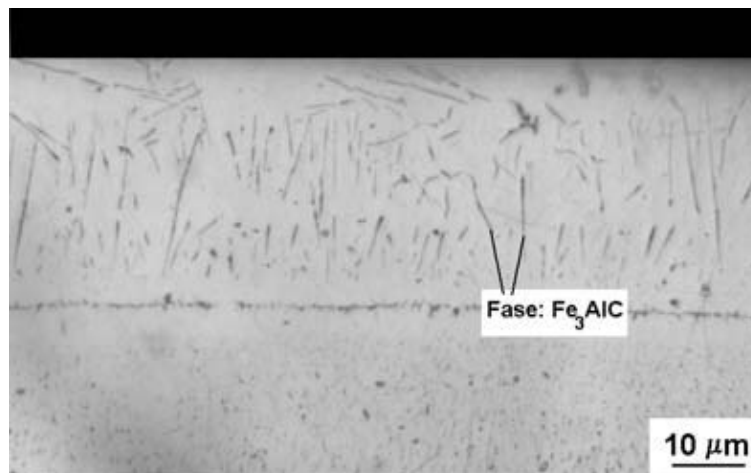
Figura 6.3.8 Micrografías ópticas de las cintas metálicas de composición Fe-40Al-5C % at., obtenidas mediante la técnica de melt-spinning, producidas a 16 m/s y tratadas térmicamente a 500 \text{ }^\circ\text{C} / 48 hrs.
