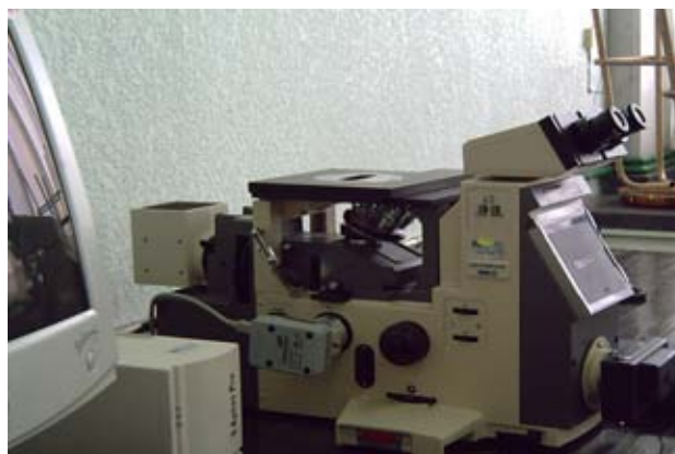
Figura 5.7 Microscopio Óptico marca Olympus de Platina invertida.
