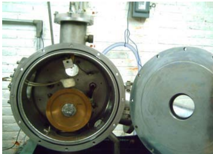
Figura 5.5 Cámara del aparato de melt spinning, en donde se muestra la bobina de inducción y la rueda giratoria de cobre.
