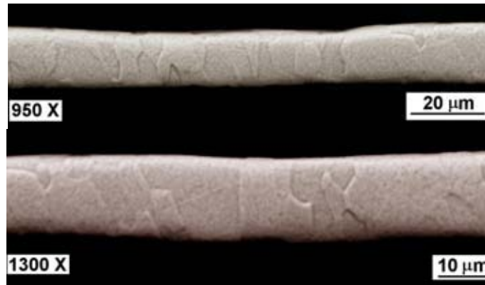
Figura 6.2.25 Micrografías electrónicas de barrido de las cintas metálicas de composición FeAlCr 2000 RPM (20 m/s).
