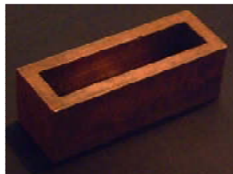
Figura 5.2 Molde de cobre empleado para el vaciado los compuestos intermetálicos fundidos.
