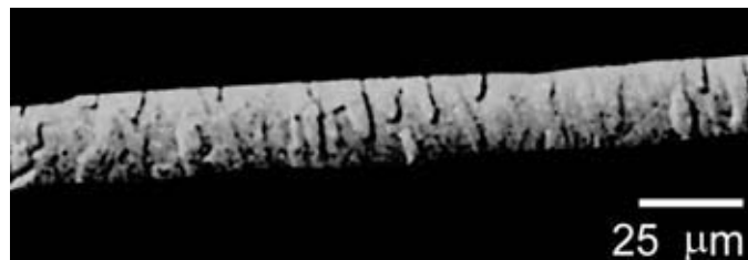
Figura 6.2.5 Micro estructura del compuesto intermetálico Fe-50Al recién producido mediante solidificación rápida por melt spinning empleando una velocidad periférica de rueda de 20 m/s (16) .
