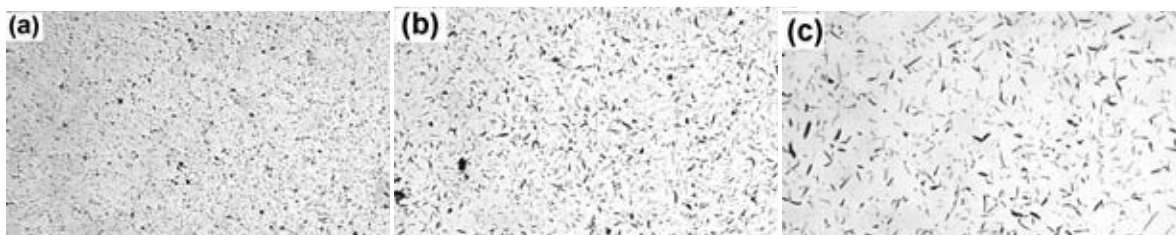
Figura 6.8 Micrografías Ópticas de la aleación base Fe40Al5C producida por inducción en crisol de alúmina sin atacar; (a) a 50X, (b) a 100X y (c) a 200 X.
