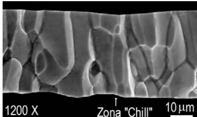
Figura 6.3.35 Fractografía a 1200 X correspondiente a la cinta de aleación Fe-40Al producida mediante “melt spinning” a (20 m/s) con tratamiento térmico a 500°C/48 hrs.
