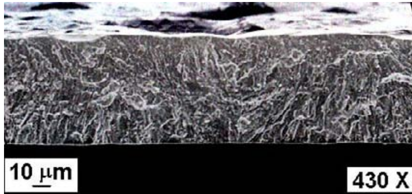
Figura 6.2.63 Fractografía a 430 X correspondiente a la cinta de aleación Fe-40Al-5C recién producida mediante “melt spinning” a 1200 RPM (12 m/s).
