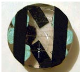
Figura 5.6 Montaje de las cintas metálicas en resina para su preparación metalográfica.
