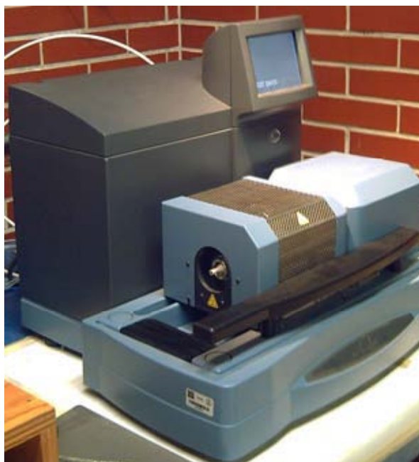
Figura 5.20 Equipo de análisis térmico SDT Q600, equipado con calorimetría diferencial de barrido.
