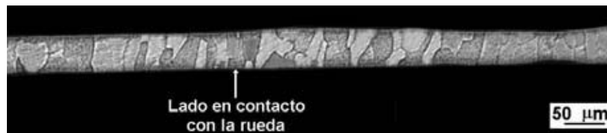
Figura 6.2.2 Micrografías ópticas de las cintas metálicas de composición Fe-40Al % at., obtenidas mediante la técnica de melt-spinning, producidas a 16 m/s.
