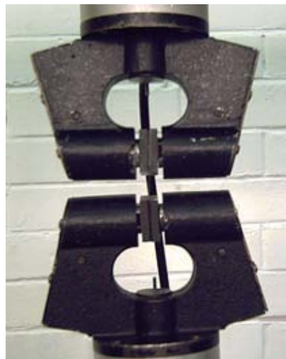
Figura 5.17 Mordazas empleadas para la sujeción de las cintas metálicas durante el ensayo de tensión.
