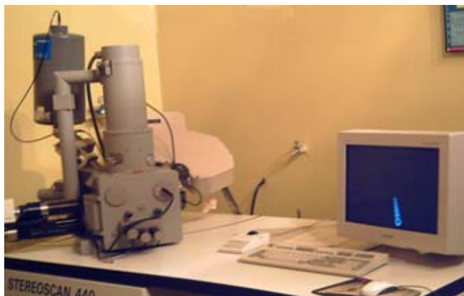
Figura 5.8 Microscopio electrónico de barrido marca estereoscan 440.
