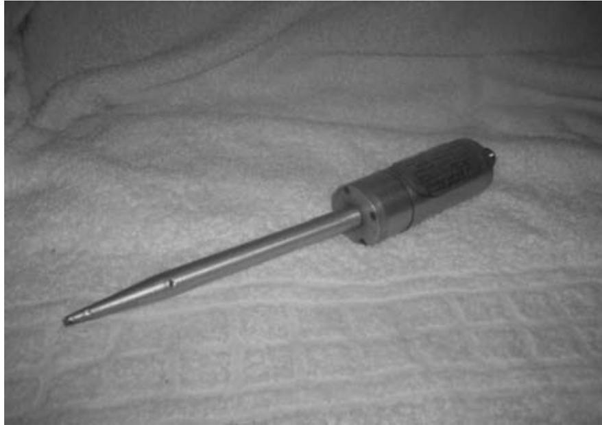
**Figura 4.6 transductor de corriente.**
