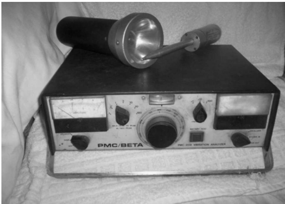
**Figura 4.5 analizador/ balanceador portátil con aditamentos.**
