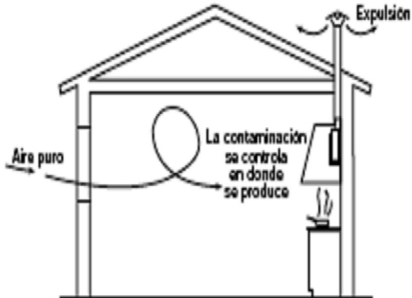
**Figura 2.24 ventilación mecánica.**
