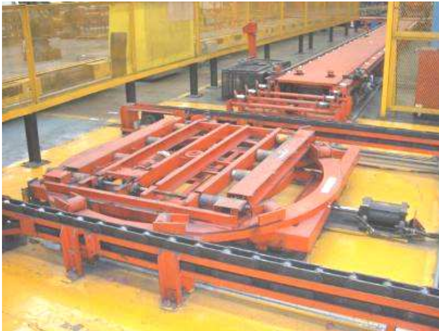
Figura 3.12. Guías rotatorias en la trayectoria del producto.
