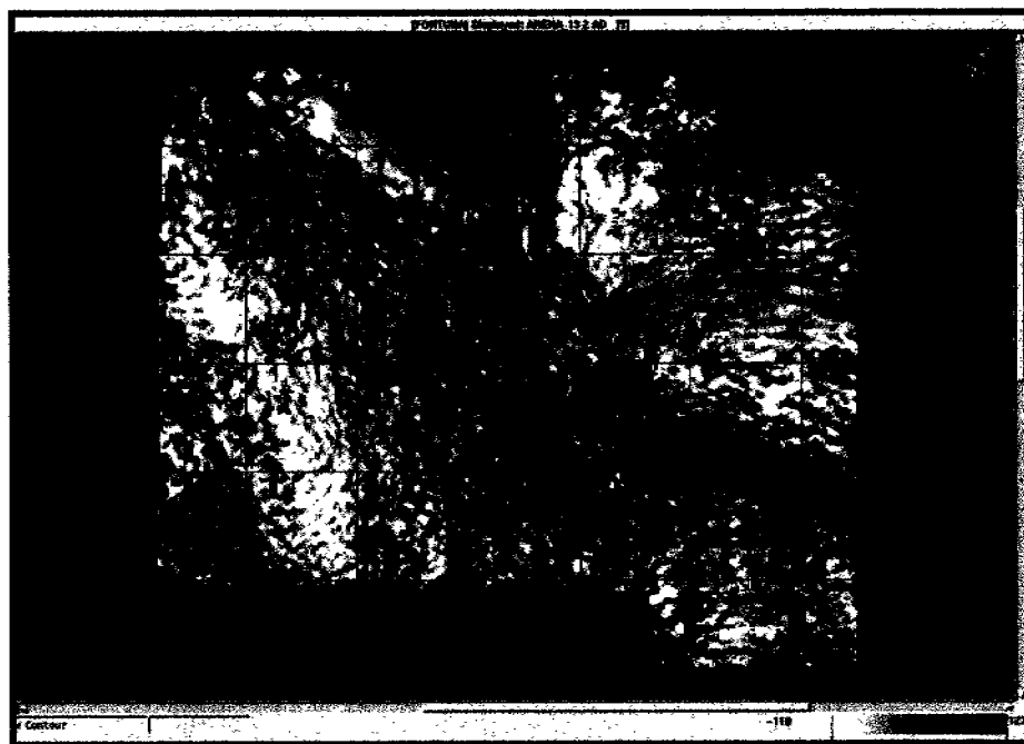
Fig. No.21.- Sección horizontal obtenida al aplicar el atributo de varianza al horizonte de la Arena-32. Nótese la tendencia por donde pasan las fallas FN_1 y FN_2. Los colores oscuros indican la presencia de arcillas y las de color claro información sísmica de buena calidad.
