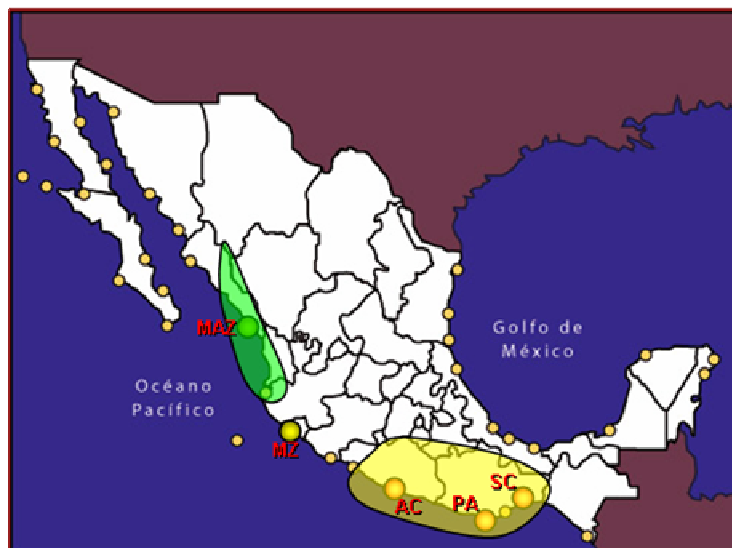
Figura 5. Las estaciones mareográficas que proporcionan los datos para el análisis están marcadas con círculos grandes (SC = Salina Cruz, PA = Puerto Ángel, AC = Acapulco, MZ = Manzanillo, MAZ = Mazatlán). Los círculos pequeños muestran la ubicación de otras estaciones mareográficas en el país. Las áreas sombreadas muestran zonas de la costa tectónicamente diferentes. Los registros mareográficos de la estación MZ se usan como referencia.
