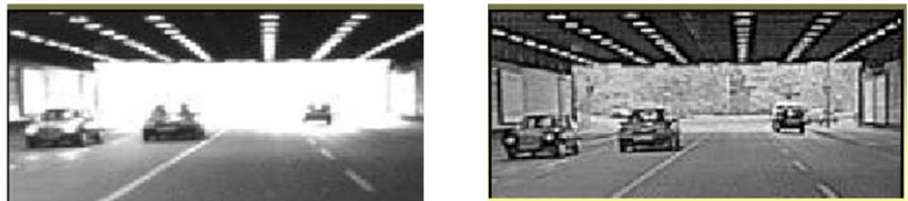
Figura 7.11. Diferencia de un rango dinámico entre sensores CCD (izquierda) y sensores CMOS (derecha).
