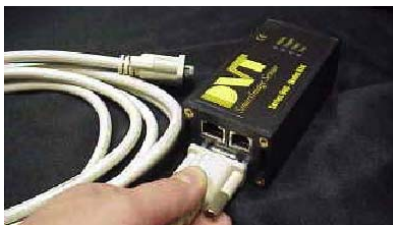
Figura 9.2. Conexión del cable de 15 pernos al Sensor de Imagen.
