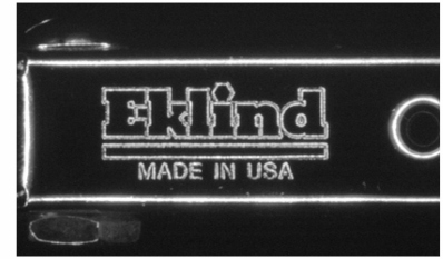
Figura 7.17 b) La misma Llave iluminada con luz Dark Field.
