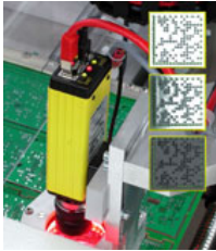
Figura 6.2. Inspección de tarjetas electrónicas.
