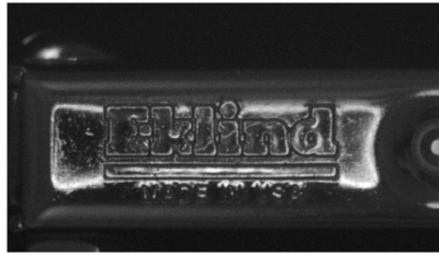
Figura 7.17 a) Llave iluminada con luz anular.
