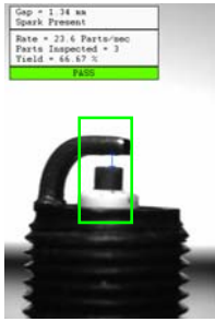
Figura 8.3 Medición entre cátodo y ánodo
