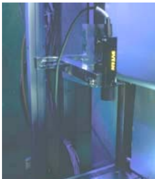
Figura 9.8. Montaje del sensor en la línea de producción.
