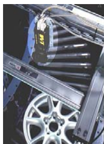
Figura 6.1. Verificación de acabado en rines.
