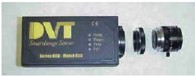
Figura 9.6. Instalación del lente en la cámara.
