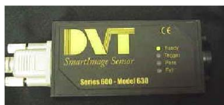
Figura 9.5. Instalación lista del Sensor de Imagen.
