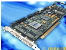
Figura 7.33 tarjeta de captura (Anaconda).
