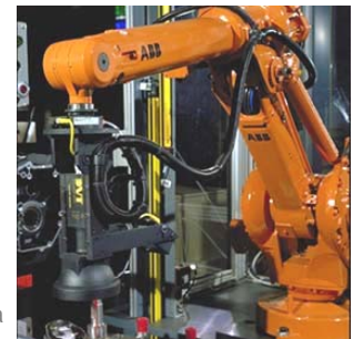
Figura 6.3. Sensor ultrasónico de peso pluma, para información de control robótico.
