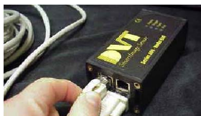
Figura 9.3. Conexión del cable Ethernet al Sensor de Imagen.
