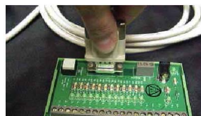
Figura 9.4. Conexión del cable de 15 pernos al panel de conexiones.
