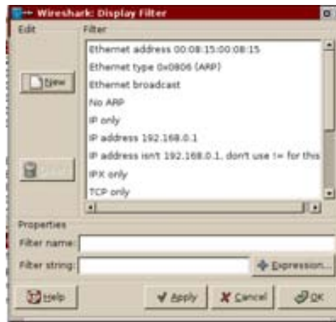
FIGURA 7.6 Filtros en Wireshark
