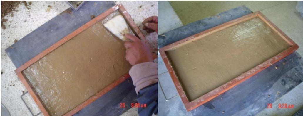
5. Se coloca al horno de secado a 60 `C
