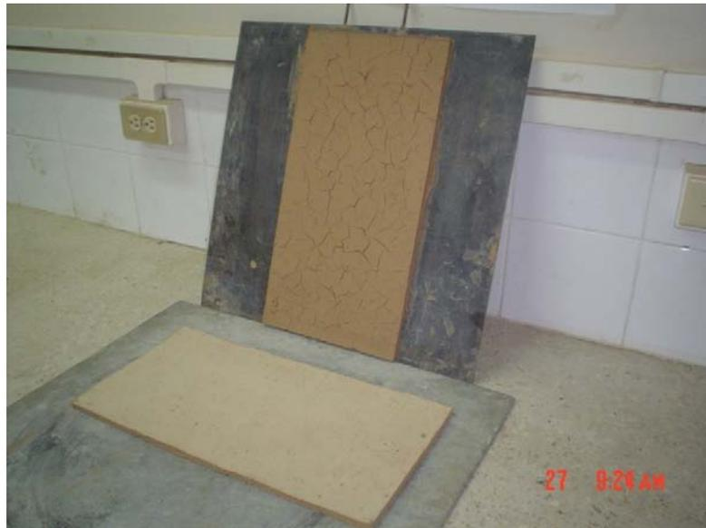
El **prototipo oscuro** elaborado con el procedimiento del ensayo 1, se muestra mucho menos resistente que el **prototipo blanco** elaborado con el procedimiento del ensayo 2, la razón principal de la mayor resistencia del prototipo blanco es la presencia de cal como cementante natural, en la composición de la mezcla de amasado, además la utilización de fibra de maguey (penco) o comúnmente llamada en nuestro medio como cabuya, la cual le brinda una mejor compacidad, flexibilidad y resistencia.
