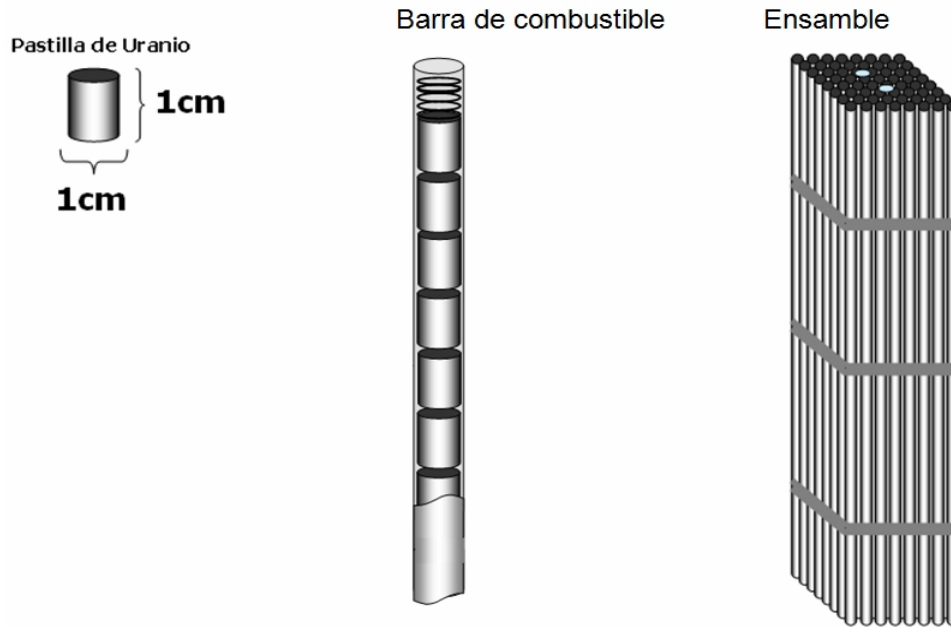
Figura 1.16 Pastillas de combustible, barras de combustible y elementos combustibles [10]
