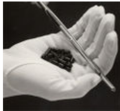
Figura 3.26 Barra de combustible compuesta por pastillas 88
