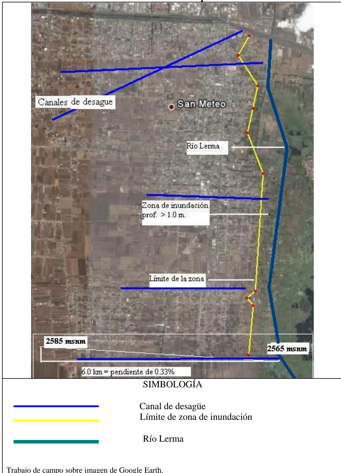
Figura 3.2 San Mateo Atenco, México: Canales de desagüe y pendiente del territorio municipal.
