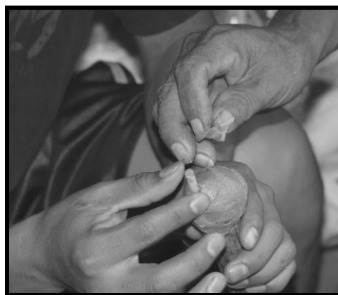
Figuras 4.51 y 4.52 Uniendo el aeroducto al tubo mediante la cera
