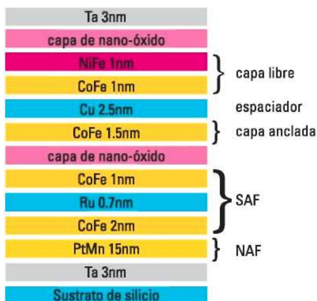
Figura 2.16 Válvula de espín utilizada como cabeza lectora de última tecnología que se utilizan actualmente para leer información de los discos rígidos. [2]
