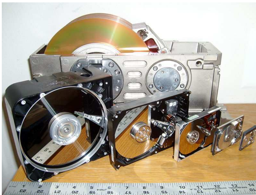
Figura 2.9 Es clara la reducción del tamaño de los discos duros y el aumento de su capacidad de almacenamiento debido a el avance tecnológico y a la miniaturización electrónica.[1]
