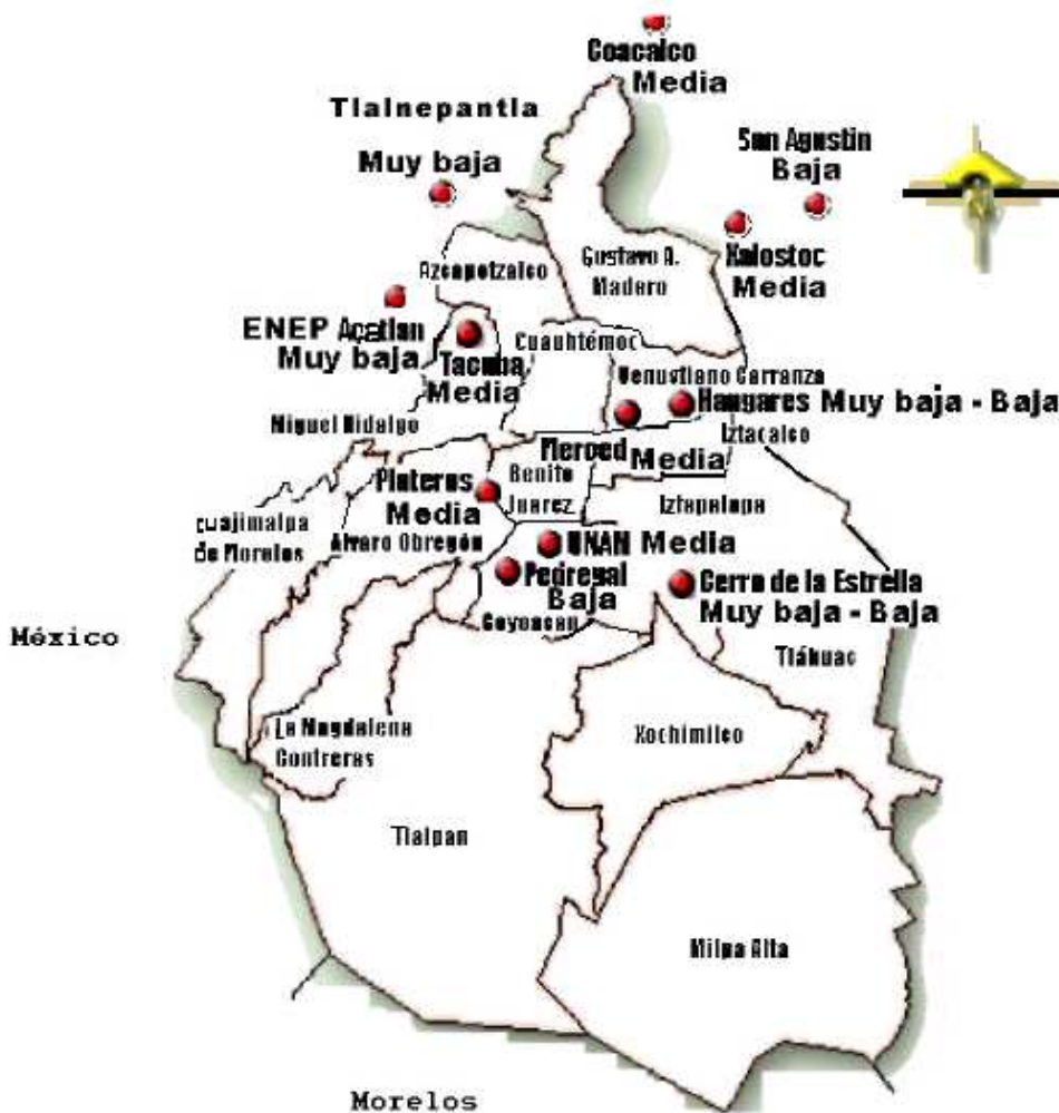
Figura 4.4 Mapa de corrosividad para el zinc, cobre y aluminio en la ZMCM [Muñoz L., et al.]
