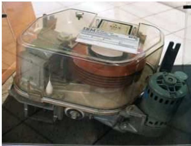
Figura 2.7 Antiguo disco duro de IBM modelo 62PC de 64.5 MB, fabricado en 1979 [1]
