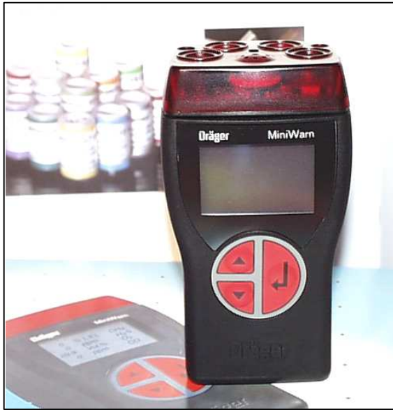
Figura 5.3 El monitor MiniWarn, usado para la detección de la concentración de SO_2 y NO_2 .
