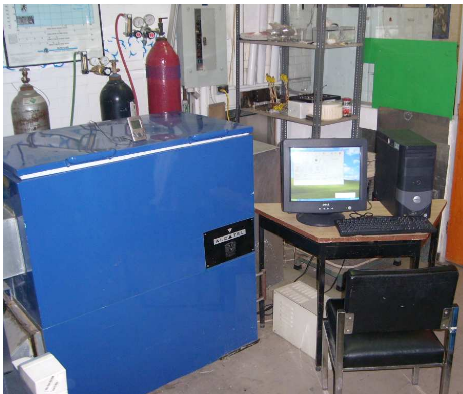
Figura 5.2 Cámara para ensayos acelerados de corrosión atmosférica.
