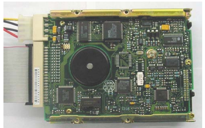
Figura 5.7 UDD para ensayo de simulación acelerada por corrosión, el cual fue protegido de los pines IDE y de alimentación.
