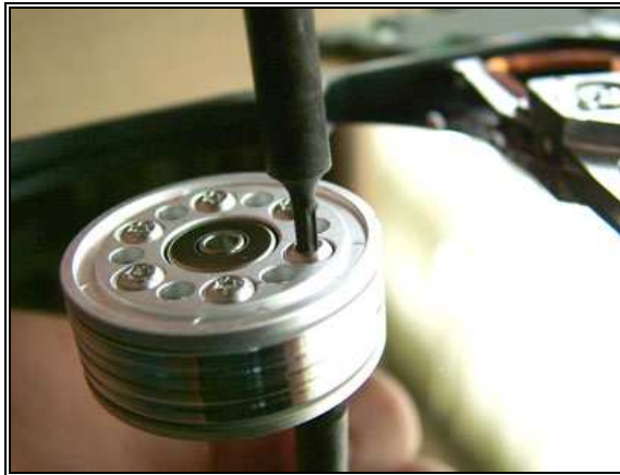
Figura 4.15 El retiro del plato y el del Brazo de debe de hacer con mucho cuidado sobre todo al desprender la C de L/E de dicho brazo para evitar la contaminación de partículas ajenas a la composición de estos y tener como resultado un análisis químico efectivo.
