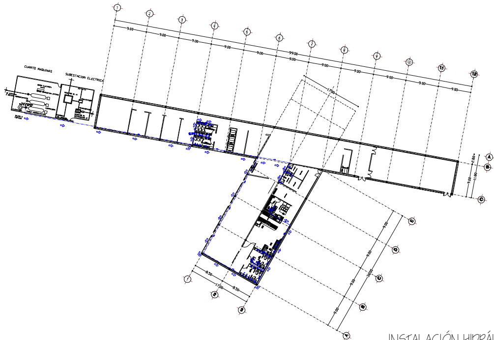
INSTALACIÓN HIDRÁULICA (AGUA FRÍA) PLANTA BA 1A
