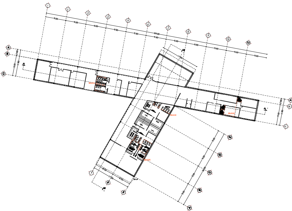
INSTALACIÓN SANITARIA PRIMER NIVEL
