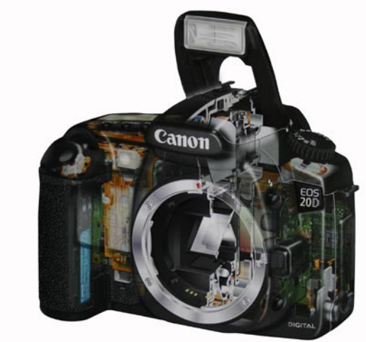
Interior de SLR digital Canon EOS 20D (Weston, Chris. "LA CÁMARA DIGITAL RÉFLEX MONOCULAR" pág.19)
