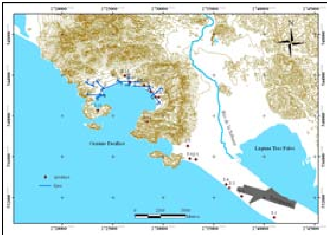
Figura 6.24. Mapa georeferenciado de la geología de Acapulco. Ubicación de sondeos y ejes geotécnicos (Flemand, 1972, León, 1976, Lazares, 2002).
