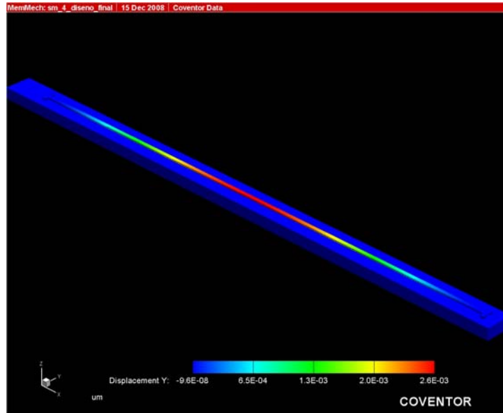
Figura 5.12.b. Desplazamientos en Y para una aceleración de 50g en dirección Y.
