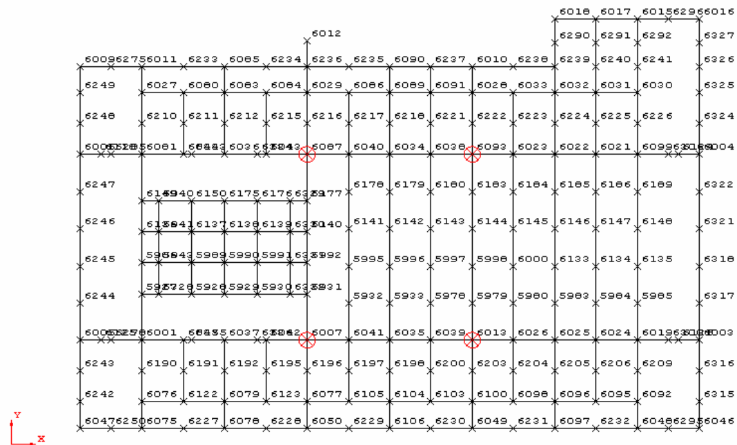
Figura 73. Orejas de izaje – Nodos cargados – Cubierta.
