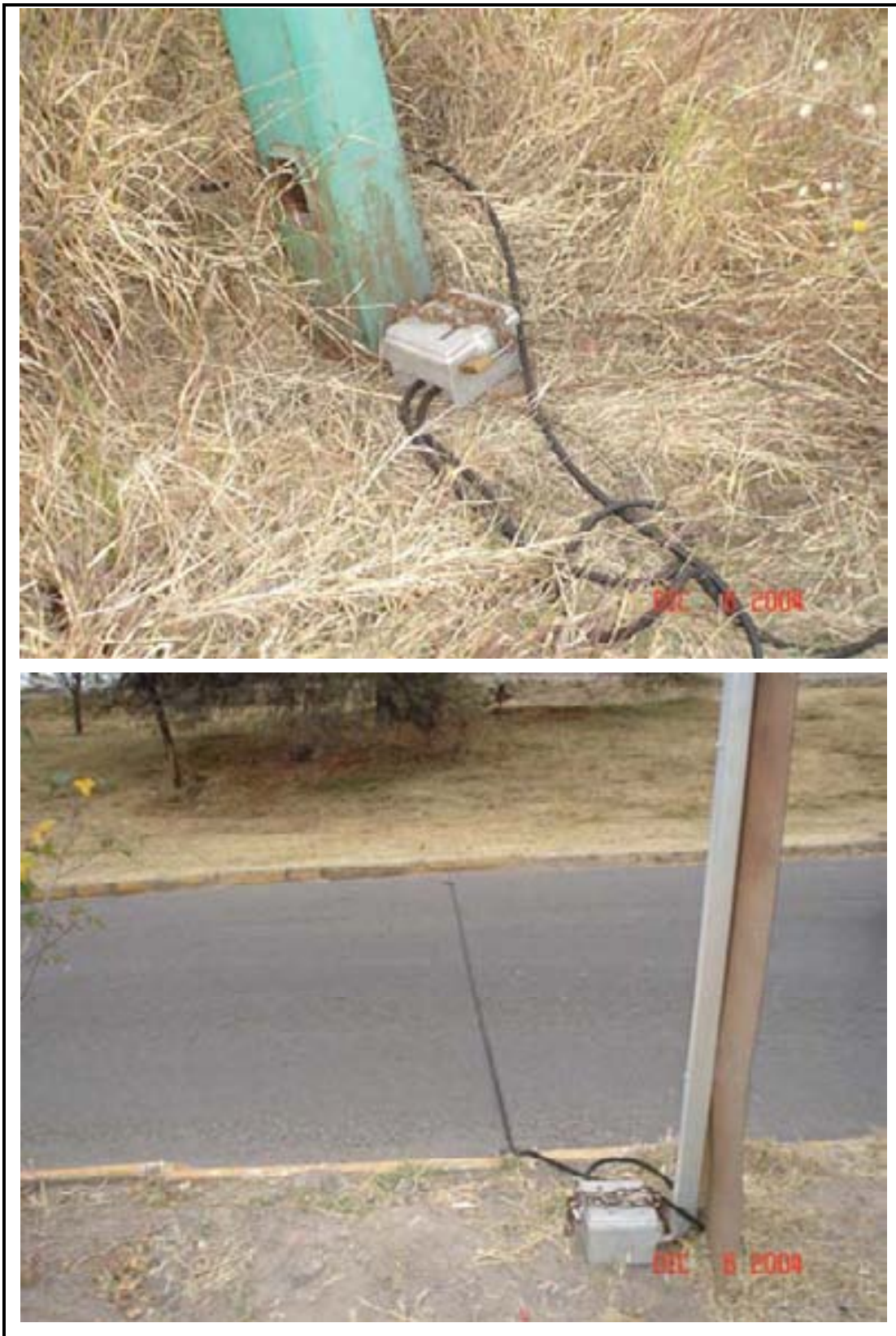
Figura 3.7.2. Aseguramiento de equipo de aforo
