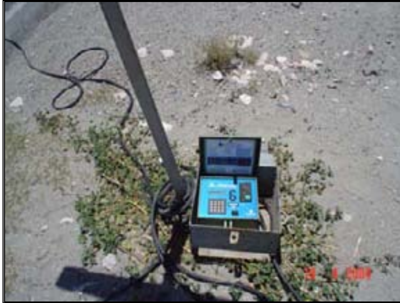
Figura 3.7.3. Equipo de aforo automático con clasificación vehicular
