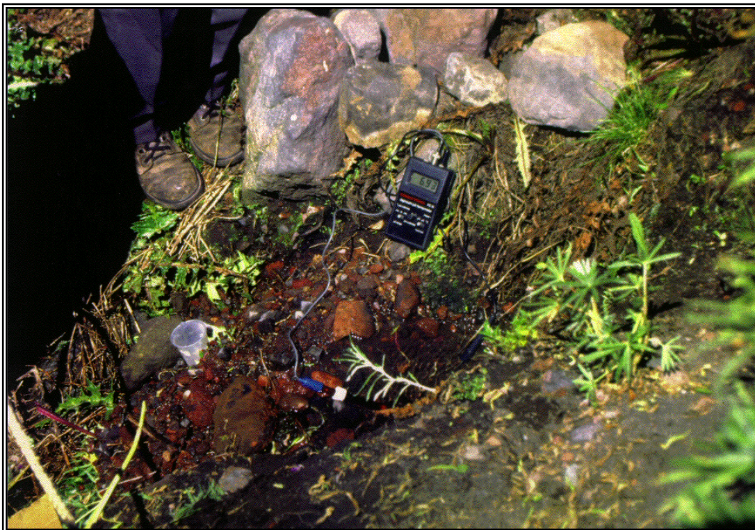
Foto 17.- Manantial de Nexpayantla, Estado de México, donde se aprecia parte del equipo para medir temperatura y pH, como parte del estudio sistemático de geoquímica que se efectúa en el volcán Popocatepetl
