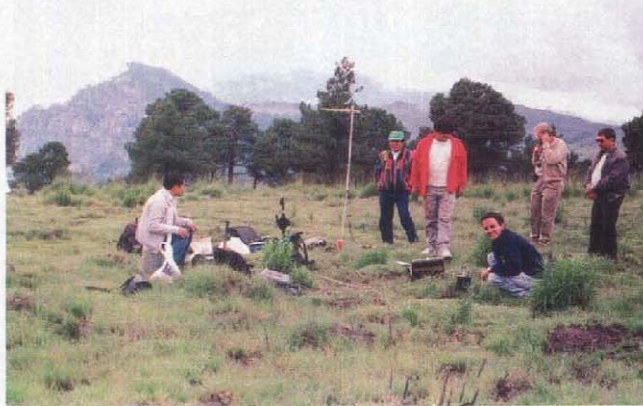
Figura 28. Selección de un sitio para la instalación de una estación sísmica. Pruebas de comunicación y telemetría con el Cenapred. Medición del ruido sísmico local. Estación Lomo del Negro (PPN), cerro Yotoxóchil, septiembre de 1994.
