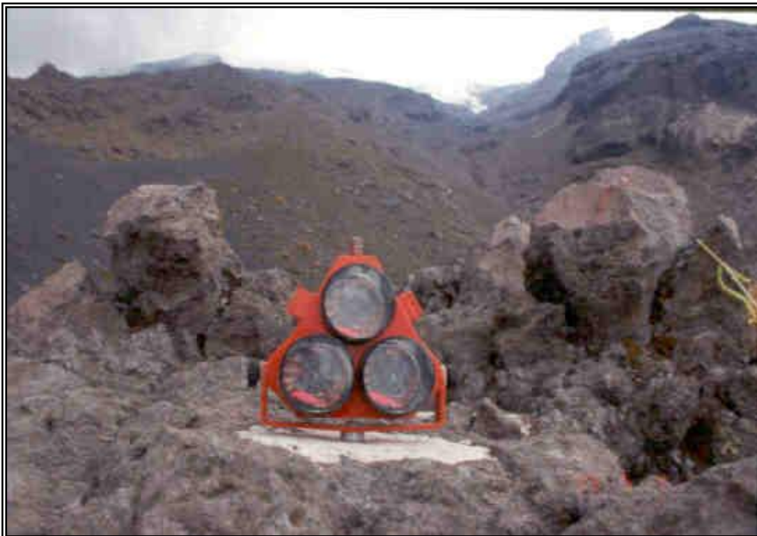
Foto 11. Prismas reflectores, donde inciden y se reflejan los rayos láser emitidos por una fuente emisora, desde una base previamente establecida en un lugar seguro, cerca de la base del cono volcánico
