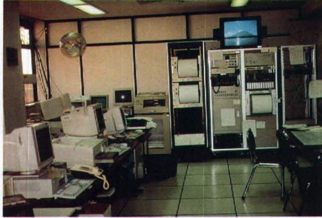
Figura 42. Vista general del puesto centralizado de recepción y procesamiento de datos del volcán localizado en el Cenapred. Al fondo a la derecha se observan los gabinetes con los receptores y graficadores de tambor de las señales sísmicas. El monitor en la parte superior muestra la imagen de video enviada en tiempo real desde el volcán al centro. Las computadoras en el lado izquierdo procesan y analizan en forma continua las señales enviadas por telemetría.
