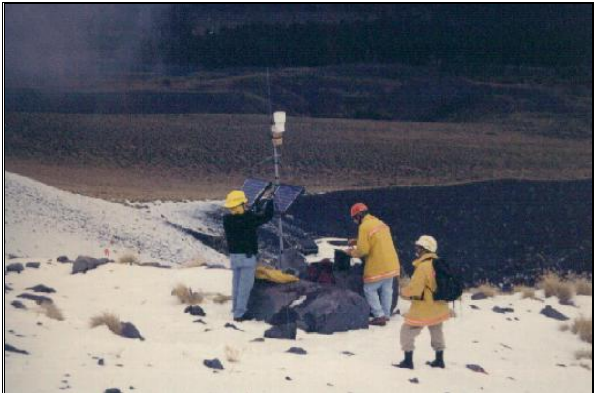
Foto 28. Sensor de vibración ubicado en la Barranca La Espinera del volcán Popocatépetl, cuya función es detectar el paso de flujos de lodo, mediante el reconocimiento de frecuencias características al paso de los mismos
