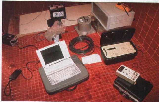
Figura 41. Instalación temporal de un acelerógrafo digital ADII, desarrollado en Cenapred e I. de I., UNAM, en el albergue de Tlamanca.
