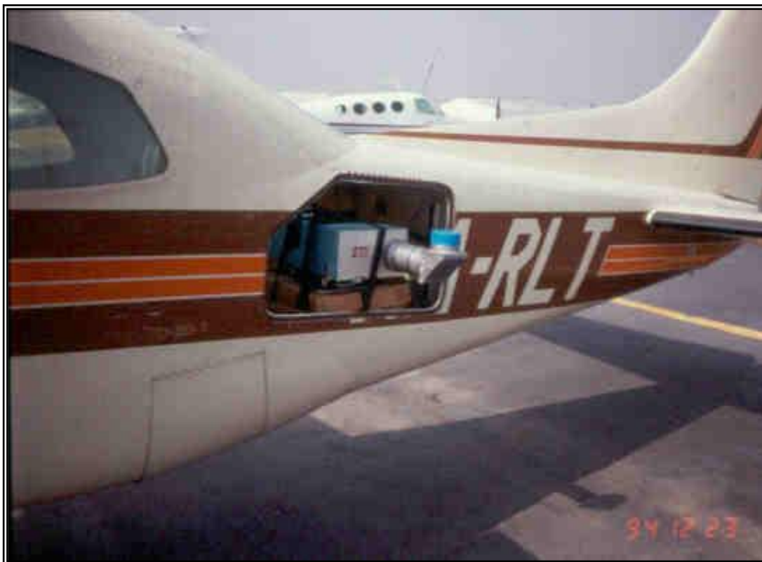
Foto 13. Espectrómetro de correlación "COSPEC" montado en avión, para muestreo de la pluma fumarólica, mediante vuelos transversales efectuados en la parte inferior de la misma
