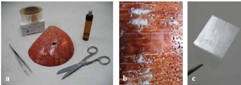
Figura 66. Elaboración de réplica: materiales empleados (a), toma de muestra (b) y polímero (c).
