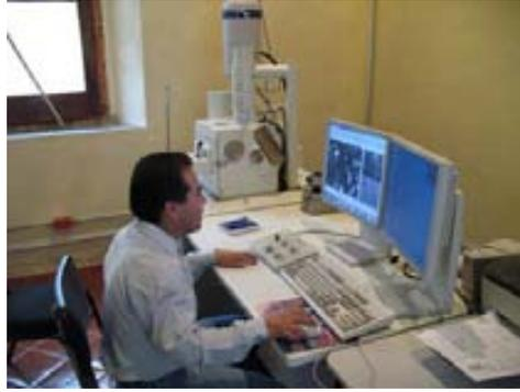
Figura 65. El Microscopio Electrónico de Barrido empleado.
