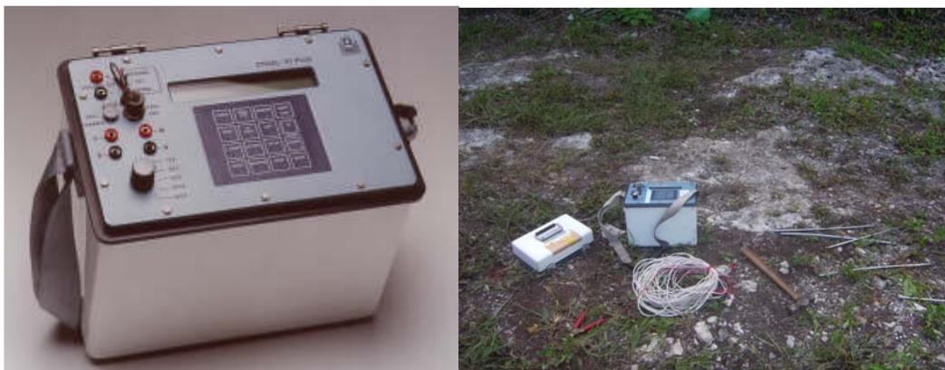
Figura 4.2 Equipo para prospección eléctrica SYSCAL R1.
