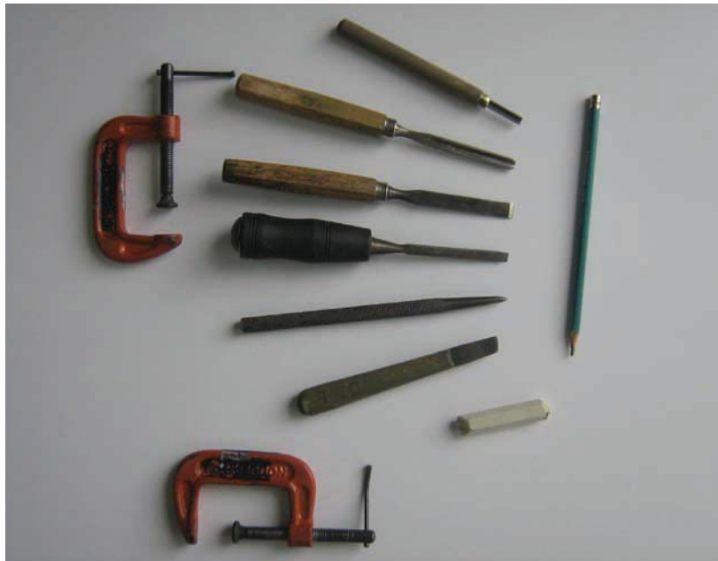
Herramientas para tallar la madera: gubias, prensas, lápices
