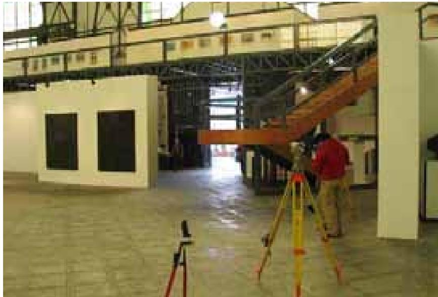
Imagen 5. Levantamiento con estación total en el interior del Museo Universitario del Chopo.
