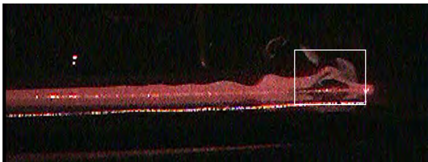
Figura 3.9. Los vórtices llegan a la etapa de descomposición después del despegue.
