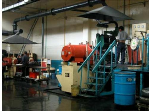
**HULES, VULCANIZADO:** Aquí el personal moldea y vulcaniza el hule para la fabricación de partes automotrices.
