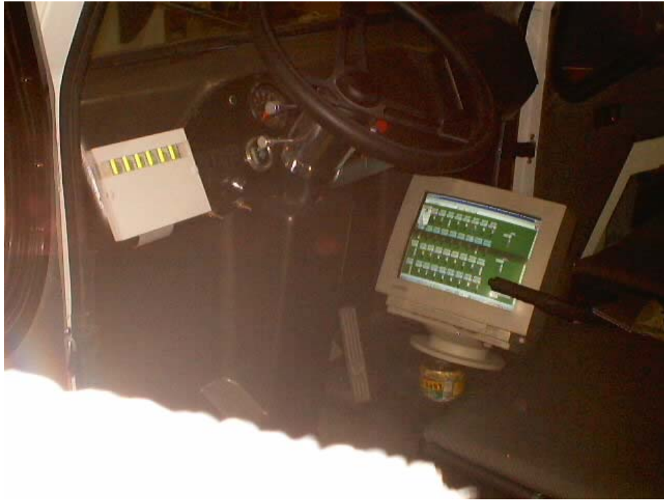
Fig.3.7. Sistema de monitoreo a bordo del vehículo.
