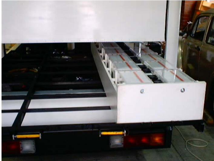
Fig.2.5. Porta baterías con 2 bancos de 8 baterías cada uno.
