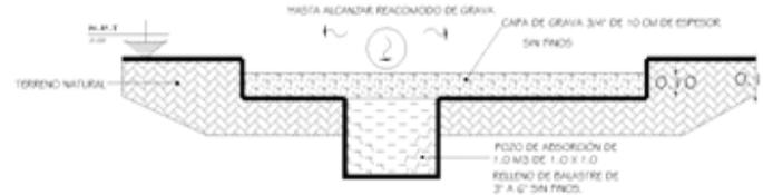
6. UNA VEZ ACOMODADA LA BASE DE GRAVA DE 3/4" Y PERFECTAMENTE NIVELADA SE PROCEDERÁ A REALIZAR LOS TRABAJOS DE COLOCACIÓN DEL CONCRETO ECOLÓGICO HECHO CON ECOCRETO CON ESPESOR DE 6 CM. CON UN f'c: 200 kg/cm2.
