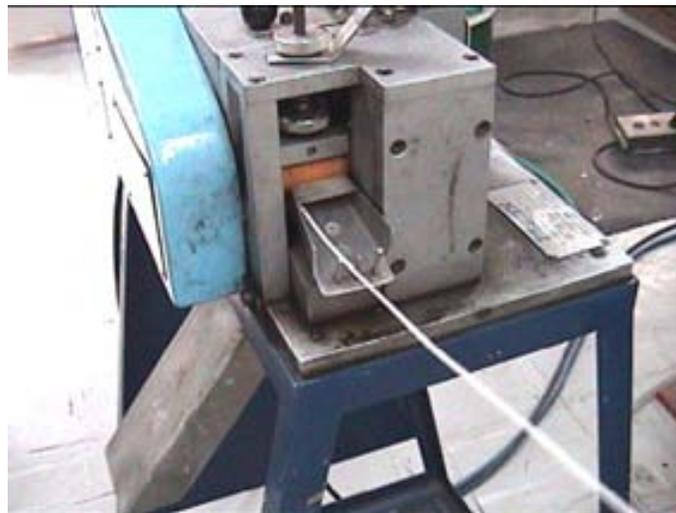
Figura 4.5: Máquina granuladora.
