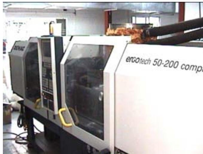
Figura 4.3: Máquina de moldeo por inyección.
