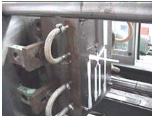
Figura 4.8: Inyección de probetas para impacto y tensión.
