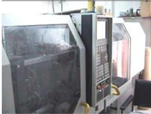
Figura 4.7: Tablero para introducir las condiciones de procesamiento.
