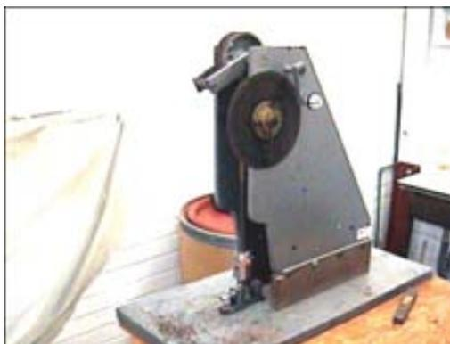
Figura 4.6: Aparato para realizar las pruebas de impacto Izod.
