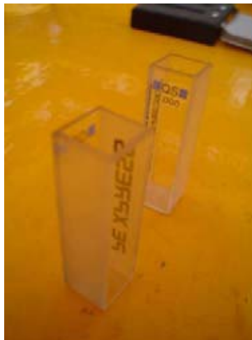
Fig. 11.- Celdas que pueden utilizarse en espectroscopia ultravioleta en prisma rectangular.
