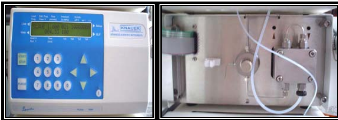
Fig. 19.- Sistema de bombeo del cromatógrafo de líquidos marca Knauer y cabezales de los pistones de la bomba (derecha).
