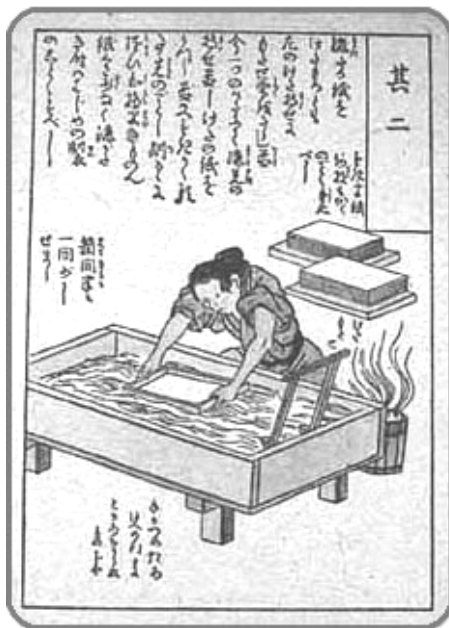
Dibujo en cerámica China de una tina llena de pasta de papel y el papelero metiendo un molde para obtener el papel, al fondo se ven las pilas de producto terminado imagen: El diseñador, Diseño Industrial, Gráfico y Digital http://www.atikoestudio.com/disenador/industrial/materiales/papel/historia%20del%20papel.htm
