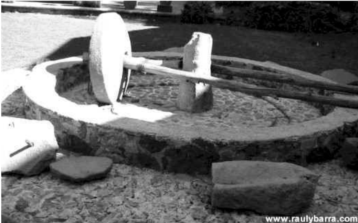
Molino de sangre, en una hacienda de beneficio en Guanajuato, estos molinos se empleaban cuando el recurso hidráulico no era tan abundante como para mover los molinos de almadenetas, fueron más comunes en Zacatecas, donde el agua era escasa y se prefería su utilización en el proceso de amalgamación y para el lavado de mineral imagen: www.raulybarra.com
