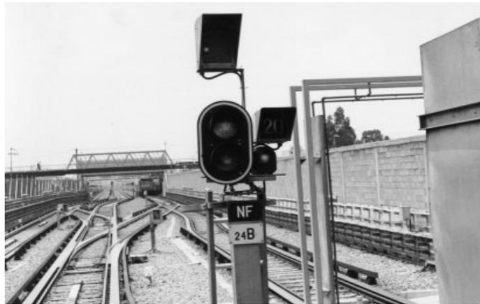
FIG. 4.5 LOS SEMÁFOROS GARANTIZAN UNA DISTANCIA DE SEGURIDAD ENTRE TRENES. STC METRO
