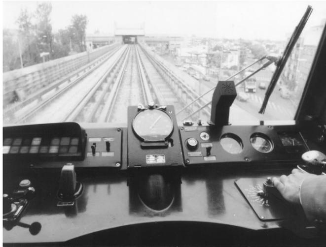
FIG. 4.6 SISTEMA DE MANDO DE UN TREN NEUMÁTICO STC METRO
