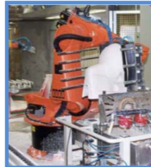
Fotografía 33. Maquina TGS es un sistema robotizado para el esmaltado del sifón de los inodoros.
