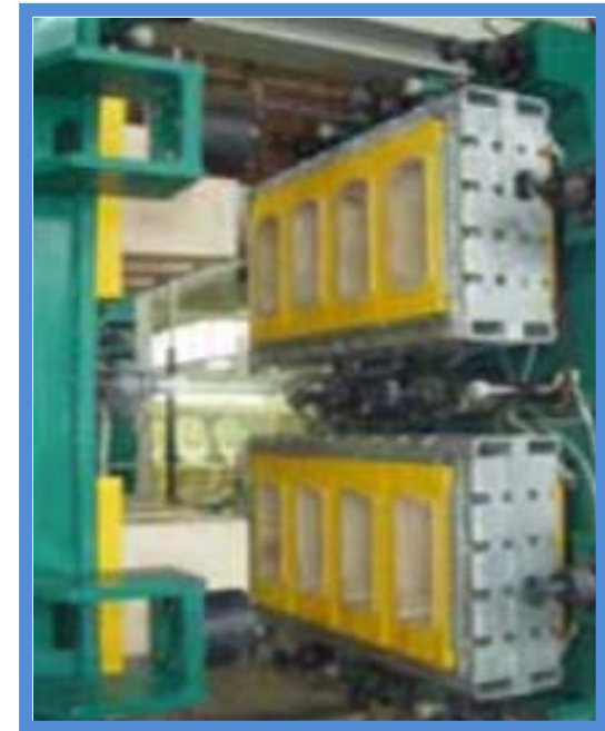
Fotografía 31. Maquina HPC 401 para vaciado en alta presión para inodoros anillo cerrado o abierto con sistema de desmolde
