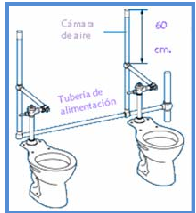
Imagen 24. Esquema de la instalación del fluxómetro.
