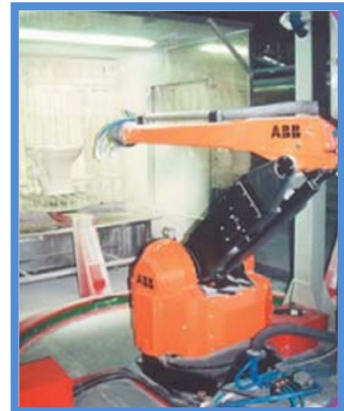
Fotografía 34. IRB-540 robot de esmaltado.
