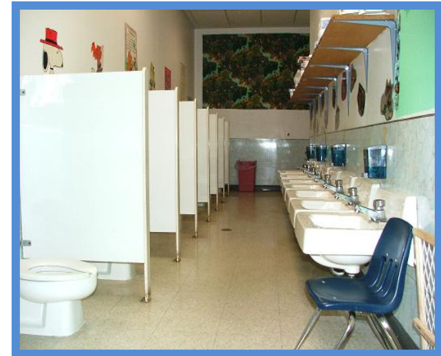
Fotografía 38. Baños de la Escuela Preescolar “Pequeño Mundo de Luz” (retomo 10 de Cecilio Róbelo No. 16 Col. Jardín Balbuena). Se observa mobiliario para adultos, colores claros en paredes y piso y una escasa iluminación haciendo ver un espacio más oscuro, para dar un toque infantil al área se decora con imágenes infantiles.
