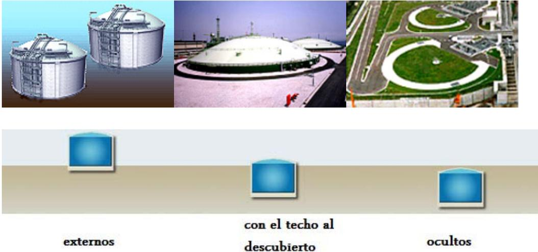
Figura 5. Tipos de tanques de almacenamiento. <sup>4</sup>
