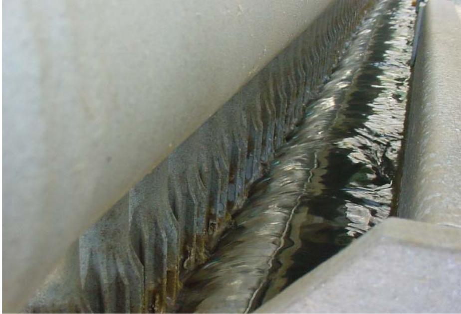
Figura 31. Agua de proceso en un vaporizador que utiliza agua como fuente primaria de calor
