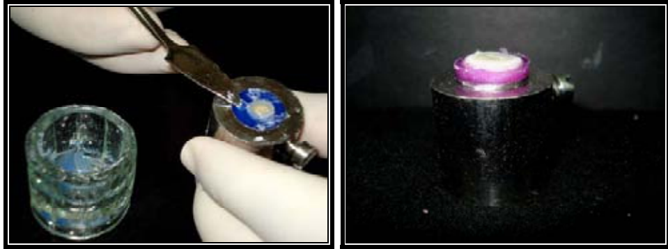
Figuras 19 y 20. Cortes montados en acrílico en el hacedor de muestras (fd)
