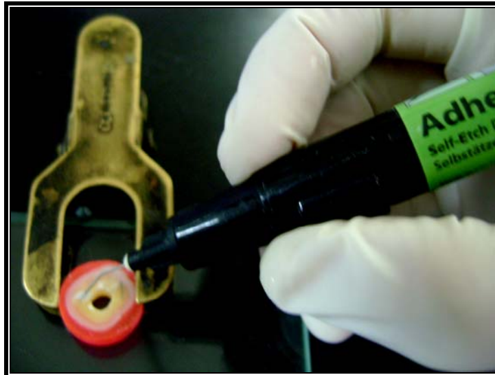
Figura 32. Aplicación de adhesivo autograbante (fd)
