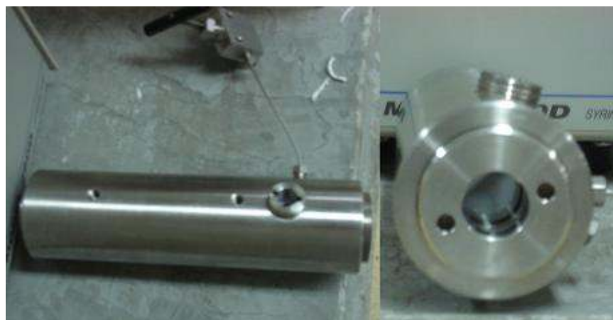
Figura 3.3. Vista lateral y frontal de la celda de reacción.
