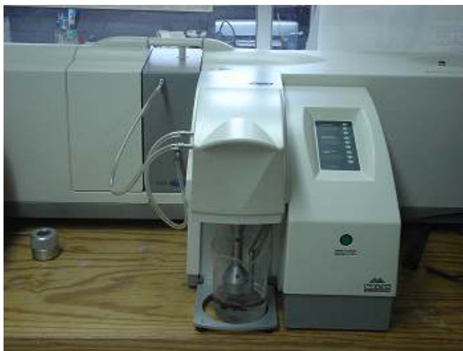
Figura 3.10. Analizador de tamaño de partículas Malvern Mastersizer 2000, acoplado a un accesorio Hydro2000Mu.
