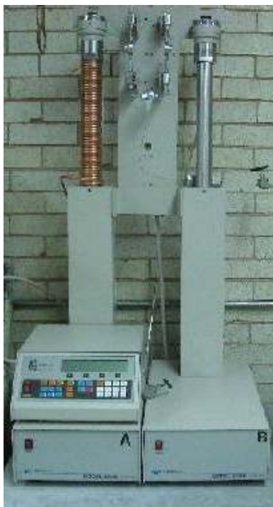
Figura 3.1. Bomba Teledyne ISCO 260D, empleada para comprimir CO 2 hasta un máximo de 517 bares de presión.
