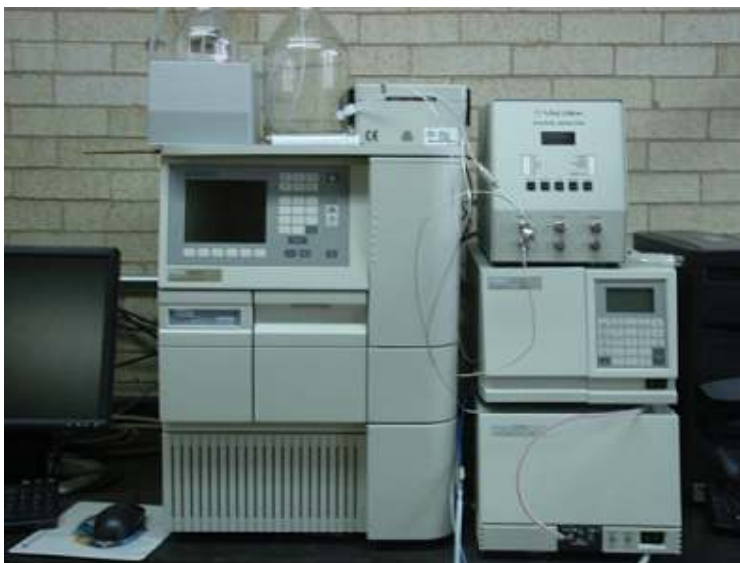
Figura 3.9. Cromatógrafo Alliance 2695 de Waters, acoplado con un banco de cuatro columnas y tres detectores.
