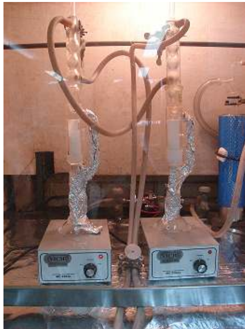
Figura 3.8. Sistema de extracción de la parte soluble, formado por un aparato Soxhlet y sus condensadores.
