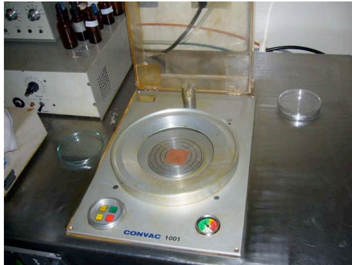
Figura 4.8 Equipo de centrifugado de Laboratorio de Fotónica de Microondas del CCADET-UNAM.
