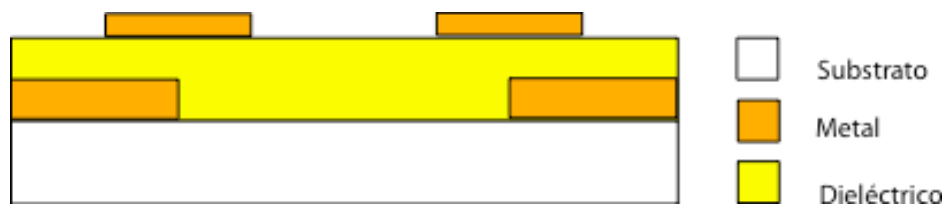
Figura 2.5 Estructura metal/dieléctrico/sustrato (Cu/BCB/Ro)
