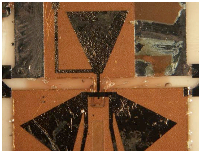
Figura 4.21 Micrografía de la vista superior de la estructura completa en donde se puede reconocer la membrana del puente del conmutador MEMS.
