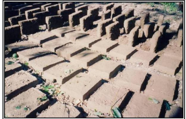
Figura 4.14. *Fabricación de adobes secados al sol. En algunas partes de la región, las propiedades aglutinantes de la tierra son muy buenas, pues no requieren de ningún aditamento extra para cohesionar. Las medidas promedio empleadas son de 40 x 25 x 10 cm. ( f.a.).*
