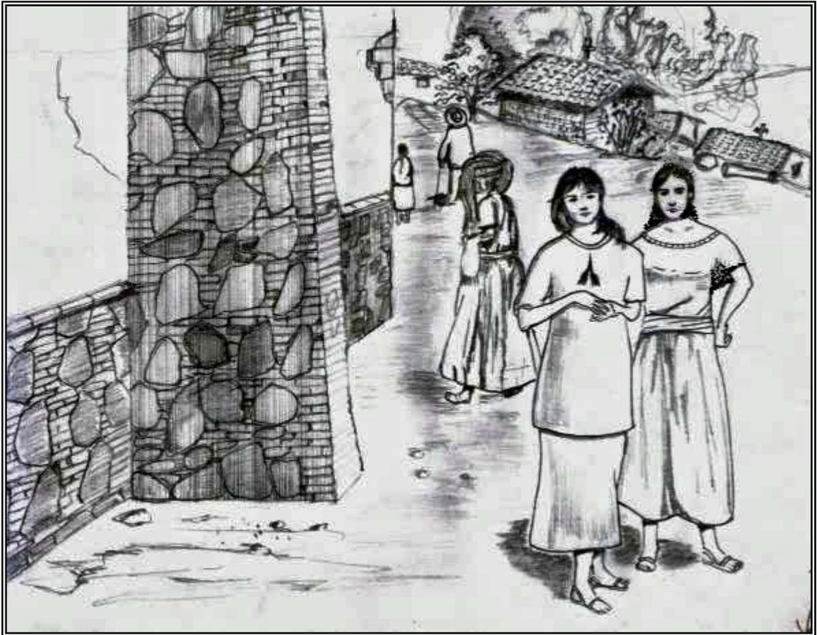
Fig. 4.18. *Detalle de contrafuerte utilizado recurrentemente en construcciones religiosas y civiles. En los elementos estructurales se colocaban piedras de gran tamaño uniéndose con lodo, savia de nopal o clara de huevo, combinándose*
