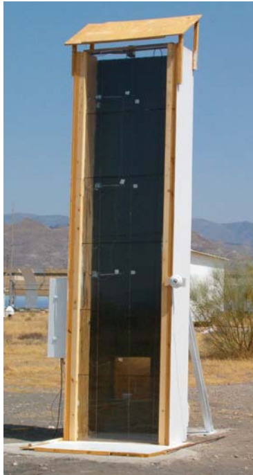
Figura 1-8. Fotografía de la chimenea solar del LECE, Martí (2003).
